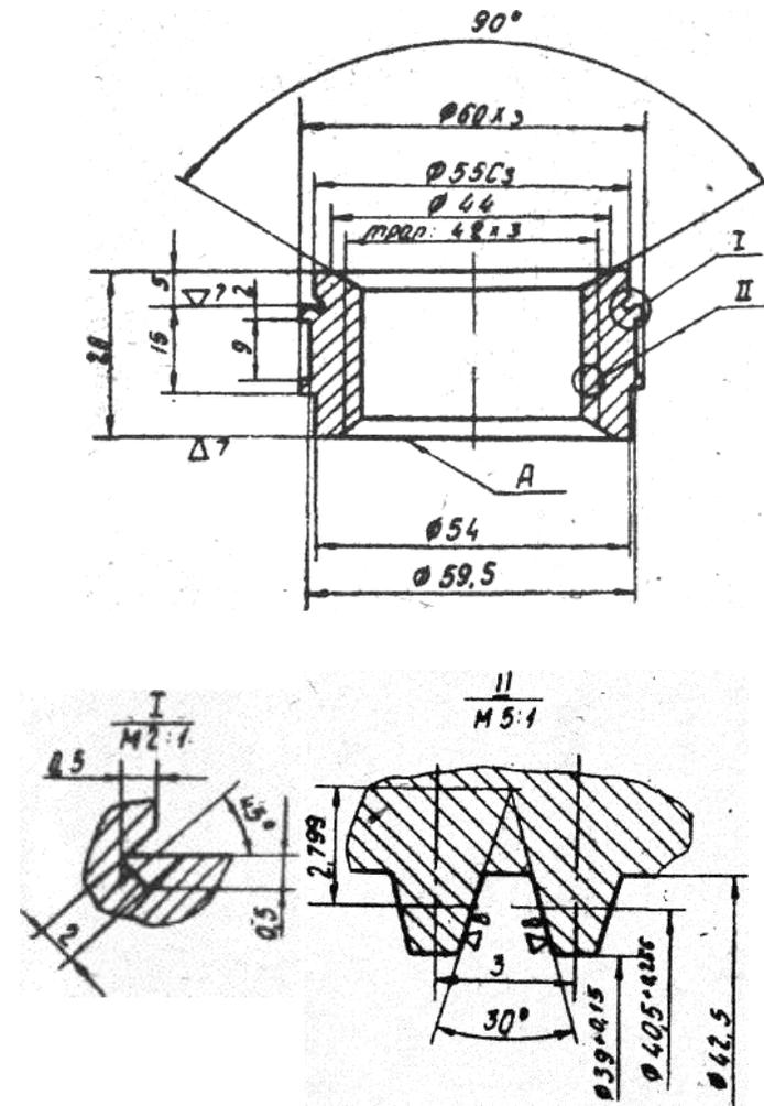
1. Неперпендикулярность поверхности А относительно оси не более 0,02 мм.
