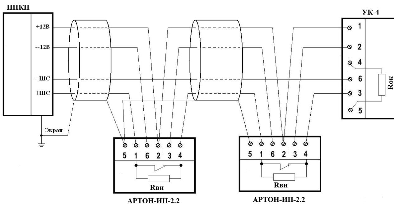
$R_{ок}$  – оконечный резистор, устанавливается согласно требований эксплуатационной документации на ППКП.
